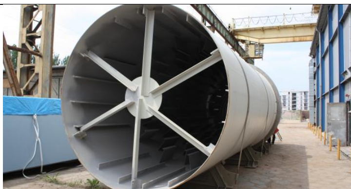
Rysunek 3. 100-tonowa suszarnia wykonana przez Makrum dla KGHM.
